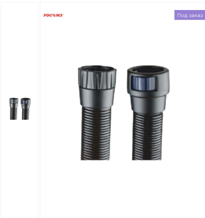
Соединительная трубка представляет собой гибкий гофрированный шланг, оснащенный переходниками для крепления к блоку подачи воздуха и к лицевой части, оснащен быстродействующим соединителем QuickLock™ для подсоединения к лицевой части. Трубка изготавливается из пластмассы. Длина трубки в сжатом состоянии 67 см, в растянутом - до 1500 см.
