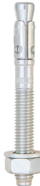
Клиновой анкер предназначен для установки шлямбурных ушей в скальной породе при пробивке маршрутов. Анкер из оцинкованной стали состоит из распорной втулки, шпильки с резьбой и конусным концом, а также фиксирующей гайки с шайбой. При закручивании гайки конусная часть раздвигает стенки втулки, надежно фиксируя анкер в толще скальной породы. Особенности Длина анкера составляет 100 мм Диаметр 10 Материал — оцинкованная сталь Масса: 195 г
