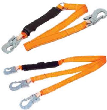
Строп ленточный с амортизатором используется как отдельная соединительная деталь, узел или компонент в системе с привязями и с анкерной точкой. Наличие амортизатора позволяет компенсировать травмоопасные динамические нагрузки на работающего при падении с высоты.
