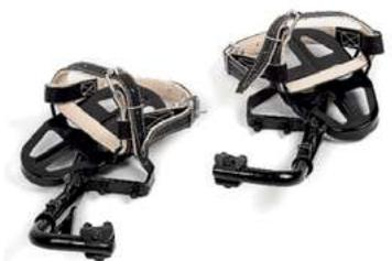
Предназначены для перемещения по железобетонным опорам трапециевидального сечения воздушных линий электропередачи типа СВ110-1а, СВ95-1а (2а), ГВ105-5. Регулировка раствора лаза осуществляется с помощью выдвигных труб, которые фиксируются двумя болтами с гайками и шайбами
