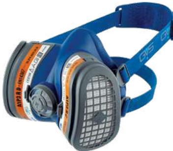
Материал корпуса из мягкого гипоаллергенного термопластичного эластомера, не содержит силикона и латекса. Защита от органических газов и паров с температурой кипения выше 65°C, от пыли, дыма, тумана, микроорганизмов.
