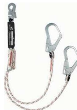
Применяется в страховочных системах для безопасной остановки падения совместно со страховочными привязями. Регулировка позволяет изменять длину каждого плеча стропа в зависимости от расстояния между анкерной точкой и опасной зоной. В комплектацию входят карабин «Стальной Монтажный малый» (арт. vpro 0052) и 2 карабина «Стальной Монтажный» (арт. vpro 0051).
