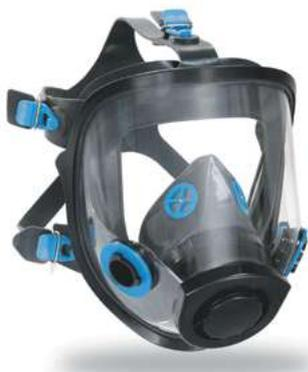
Маска состоит из панорамного стекла-корпуса, силиконового уплотнителя с двойным обтюратором, клапанной коробки с клапаном выдоха и перегородным устройством, силиконового подмасочника с клапанами вдоха и силиконового оголовья.
