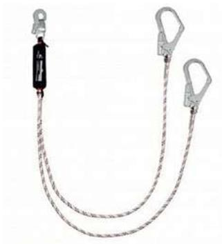
Применяется в страховочных системах для безопасной остановки падения совместно со страховочными привязями. В конструкцию включен амортизатор рывка. Узлы стропа защищены прозрачной термоусадочной пленкой, обеспечивающей возможность визуального контроля. В комплектацию входят карабин «Стальной Монтажный малый» (арт. vpro 0052) и 2 карабина «Стальной Монтажный» (арт. vpro 0051).
