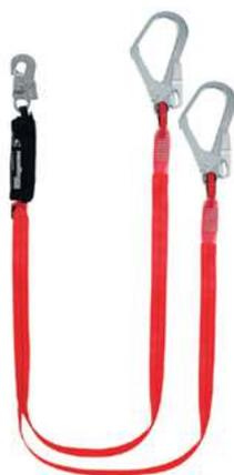
Изготовлены из текстильной ленты шириной 30 мм, выдерживающей нагрузку 22 кН.
